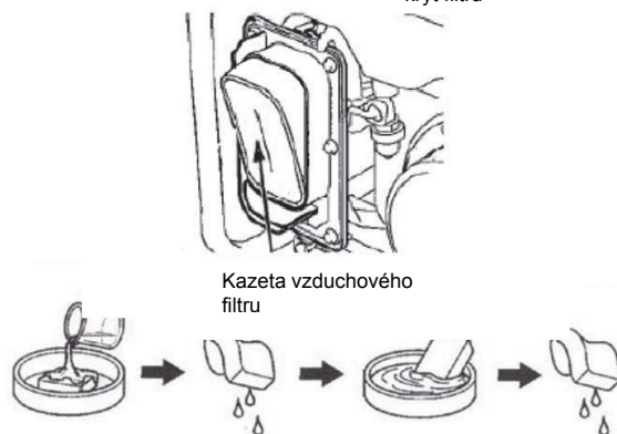
Obr. 20: Čistění vzduchového filtru
